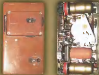
Приемник радиостанции «БЕЛКА» собран на двух лампах.
