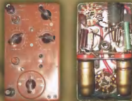
Передатчик радиостанции «БЕЛКА» собран на двух лампах.
